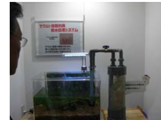
ヤクルト容器を再利用した水の浄化装置
